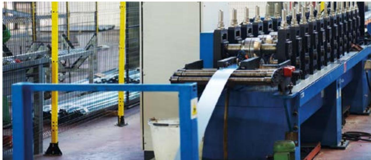
Profilatura lamiera per produzione strutture metalliche per porte.
