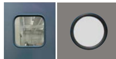
In gomma realizzato con profilo perimetrale in EPDM nero ad angoli stondati Ø 260 mm, che permette l'inserimento di vetro stratificato fino a 10 mm di spessore.
