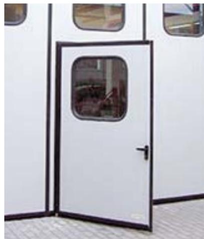
Porta pedonale senza inciampo disponibile sui modelli LG e sulle versioni LN e LE installate all'esterno. Porta con telaio in alluminio nero su tre lati completa di maniglione antipanico a due punti di chiusura laterali con cilindro e maniglia esterna.
