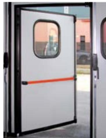
Anta tagliata, disponibile solo sui modelli SN, con profilo superiore di battuta nero, dotata di maniglione antipanico pushbar a due punti di chiusura verticali/laterali con cilindro e maniglia esterna.
