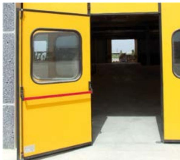
Anta tagliata, disponibile solo su modelli LN e LE, con profilo di battuta superiore in alluminio nero, dotata di maniglione antipanico con 2 punti di chiusura (alto/basso), con cilindro e maniglia esterna. L'incontro aereo rende solidale la porta con il pannello superiore laterale, una speciale staffa permette una battuta ottimale sulla battuta a terra.
