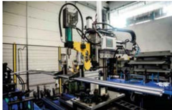
Robot di montaggio strutture metalliche porte sezionali.
