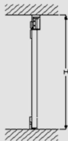
Montaggio IN LUCE con e senza guida inferiore, in luce in altezza
