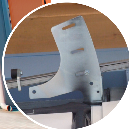
PIASTRA PER ROTAZIONE A 180° 180° ROTATING PLATE
