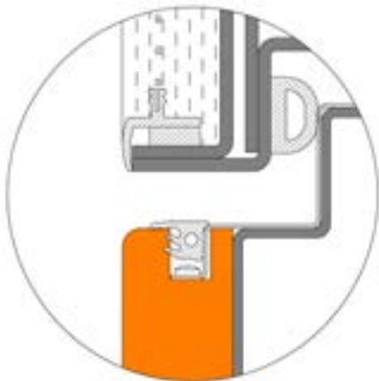
Controtelaio raso muro interno e esterno con retina speciale per tenuta intonaco Counterframe flush with internal and external wall + special plaster net
